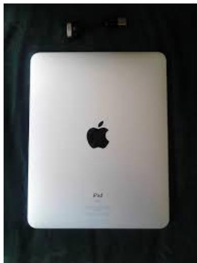
**3.- iPad.-** Procesador: Chip Apple A4 a 1 GHz diseñado a medida (SoC) basado en un diseño de núcleo único ARM Cortex A8. Memoria flash de 16 GB. Tarjeta gráfica: **PowerVR SGX 535**. Procesador gráfico (GPU) integrado en A4). Sistema operativo: **iPhone OS 3.2** (build 7B298g) los primeros modelos, ahora vienen con la versión de **iOS** actual. Wi-Fi. Localización geográfica. TV y video.
